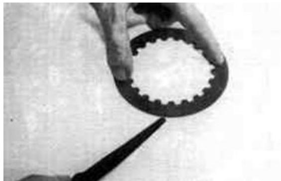
Fare un controllo visivo tra i denti. Se vengono riscontrati macchie di fatica termica, perdita di durezza superficiale o una usura non omogenea dei denti sostituire il componente.
