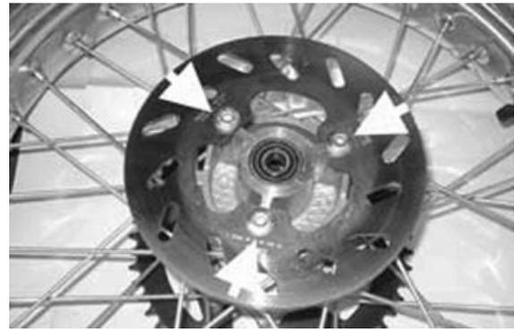
**Disco freno anteriore****Sostituzione disco freno**
